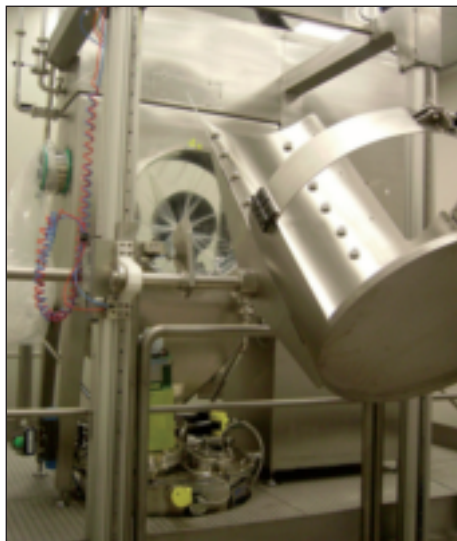
Isolatore con dispositivo di carico/scarico materia prima a "liner continuo" Glove Box with charging/discharging device of raw material to "continuous liner"
